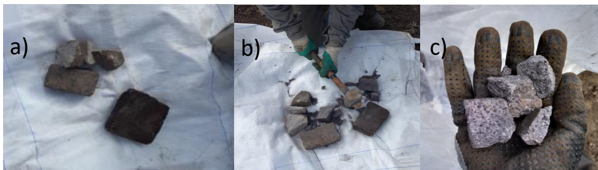
Figura 13 – a) Amostra Inicial; b) Quebra manual das amostras; c) Amostra final
