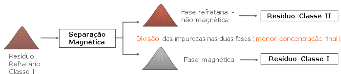
Figura 11 - Representação esquemática da separação magnética
